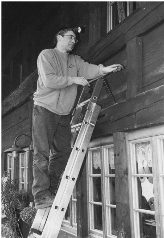
Dendrochronologische Probenentnahme an der Südfassade des Hauses (Aufnahme Bauernhausforschung 1999)
