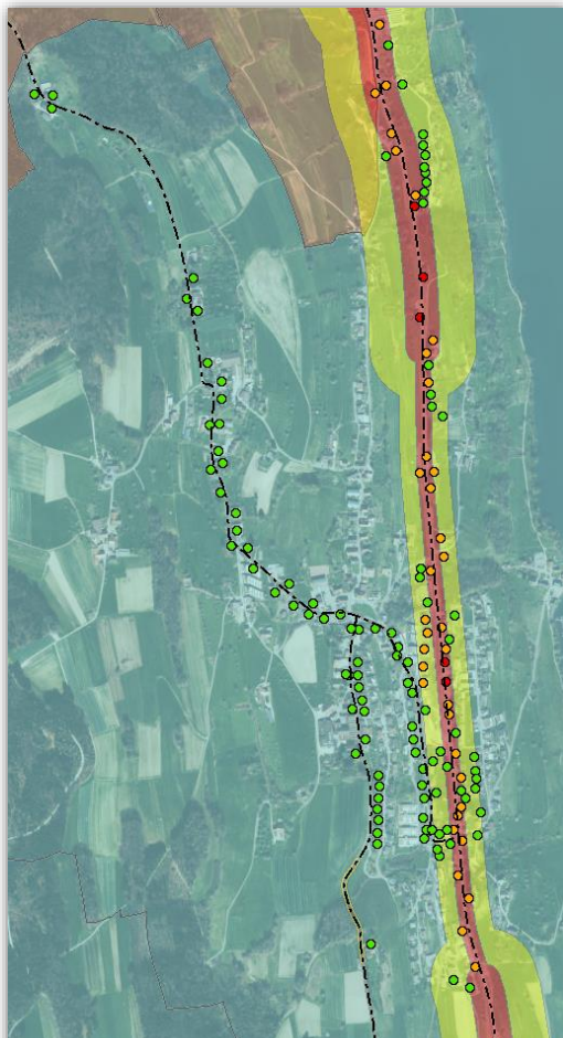
Abbildung 21: Die Strassenlärmkarte zeigt an wo Alarmwerte (rote Punkte) und Immissionsgrenzwerte (orange Punkte) überschritten werden. Quelle: agis, Strassenlärm. 29.09.2017
